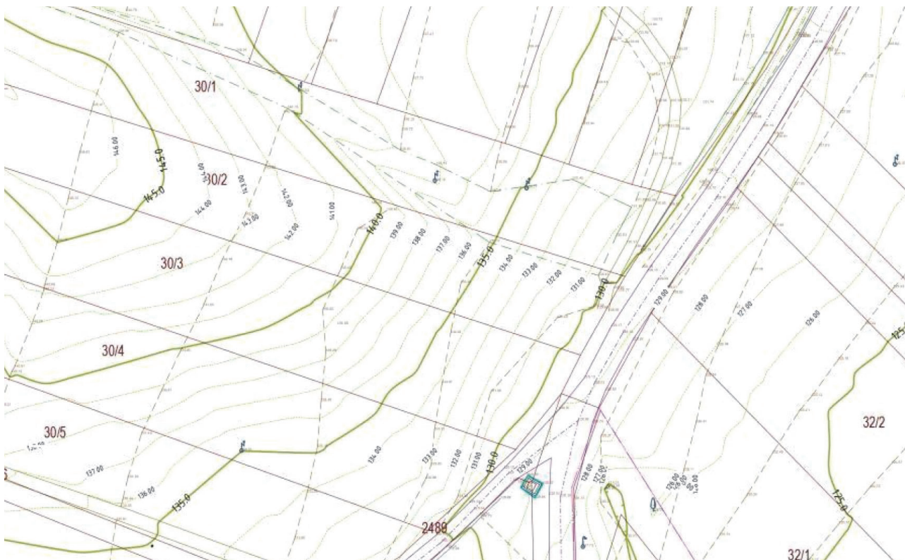
Slika 1. Standardni 2D prikaz postojećega terena u CAD aplikacijama
