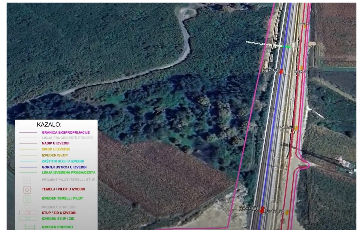
Primjer praćenja složene organizacije građenja zahvata linijske infrastrukture
